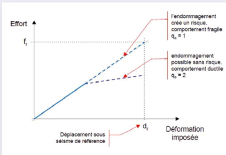
Figure 2-1 : Principe du coefficient de comportement  $q_a$
