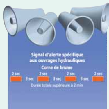
Signal national d'alerte spécifique rupture de barrage. Le réflexe : évacuer.
