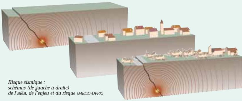
Risque sismique : schémas (de gauche à droite) de l'aléa, de l'enjeu et du risque (MEDD-DPPR)
